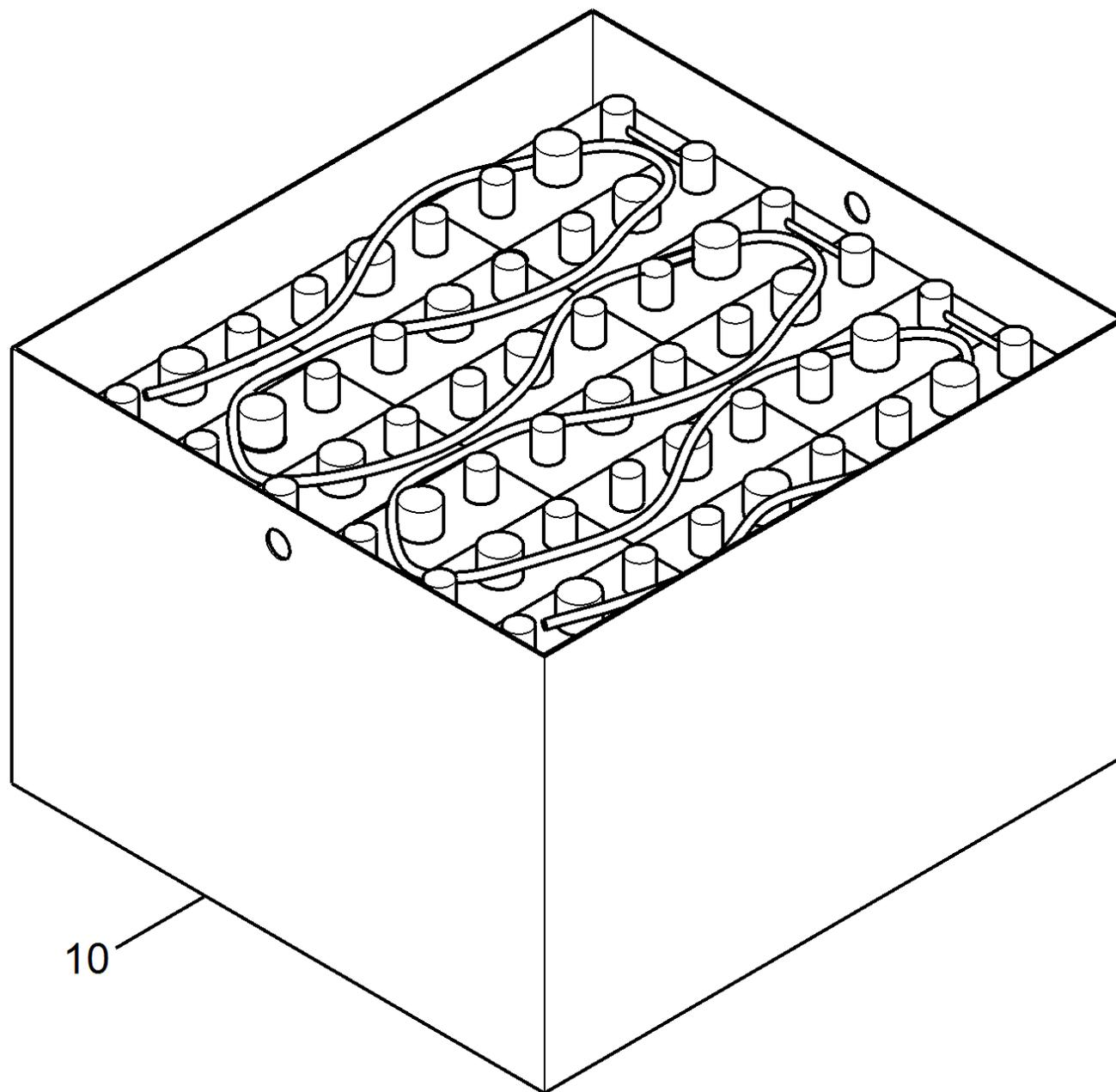
999 ETL Batteriesatz Trog 240 Ah (5.972-706.0)
