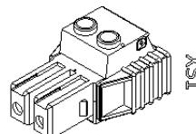
Steckverbindung schraubar und steckbar Phoenix Contact, 2-polig
