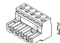
Steckverbindung schraubar und steckbar
