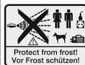
Hochdruckstrahlen können bei unsachgemäßem Gebrauch gefährlich sein. Der Strahl darf nicht auf Personen, Tiere, aktive elektrische Ausrüstung oder auf das Gerät selbst gerichtet werden.
