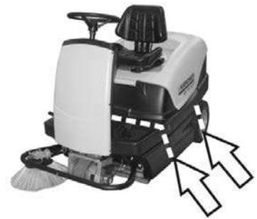
**Hinweis:** Markierungen für Befestigungsbereiche am Grundrahmen beachten (Kettensymbole). Das Gerät darf zum Auf- oder Abladen nur auf Steigungen bis max. 18% betrieben werden.
