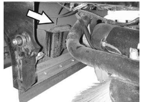
Schlauchanschluss zur Unterdruckdose der Seitenbesenabsenkung
