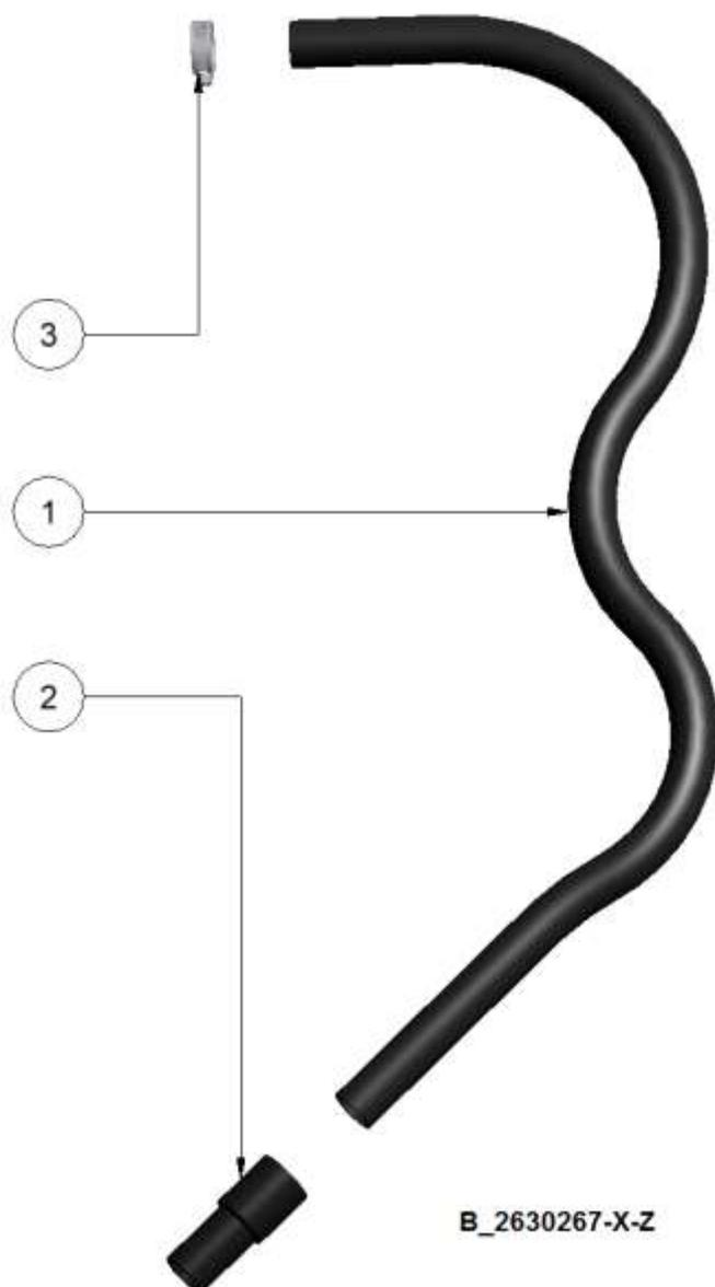
12.10.1 Druckausgleichsschlauch Typ "A" ø25, (2630267)
