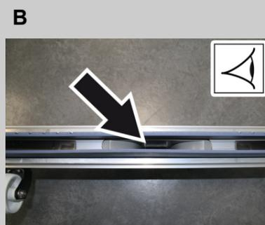
A Sauglippen im Saugbalken reinigen und auf Abnutzung prüfen.
