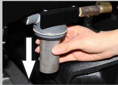
A Filter Frischwasser prüfen, bei Bedarf reinigen.
