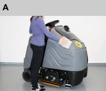
A Gerät außen mit feuchtem, in milder Waschlauge getränktem Lappen reinigen.
