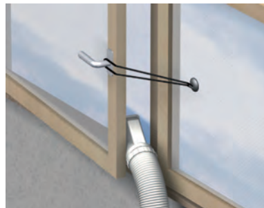
Abb. 10: Abluft bei geöffnetem Fenster
