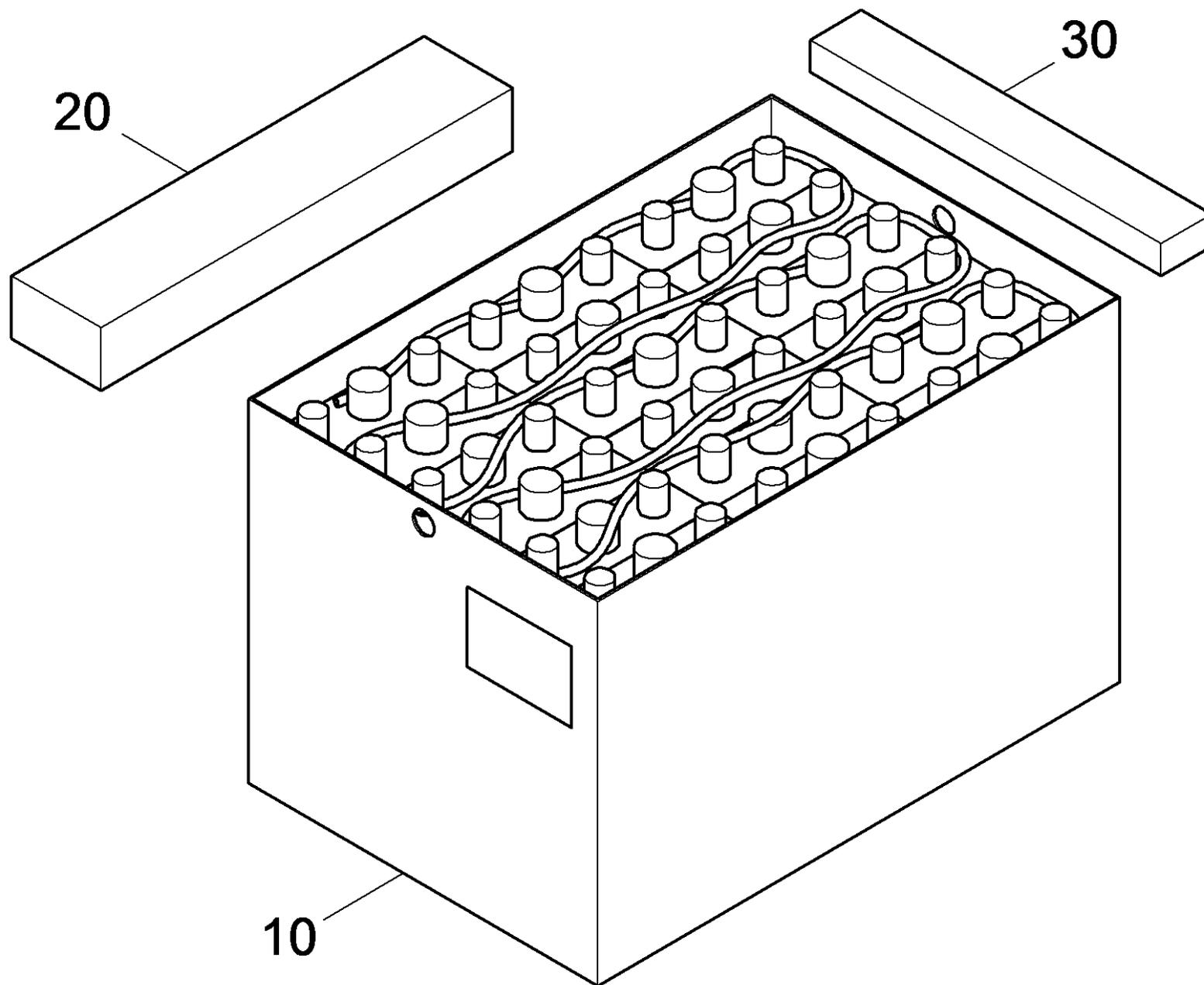
999 ETL Batteriesatz Trog 180 Ah (5.972-707.0)
