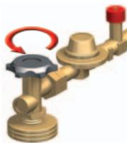
**Bei gleichzeitiger Entnahme aus mehreren Gasflaschen müssen alle Ventile geöffnet werden.**
