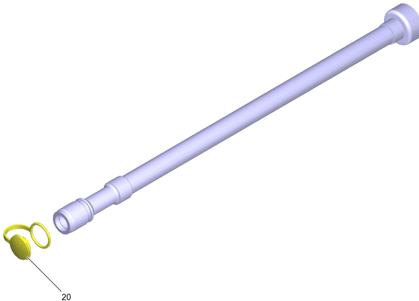
210 Ablassschlauch mit Deckel PU (4.035-285.0)
