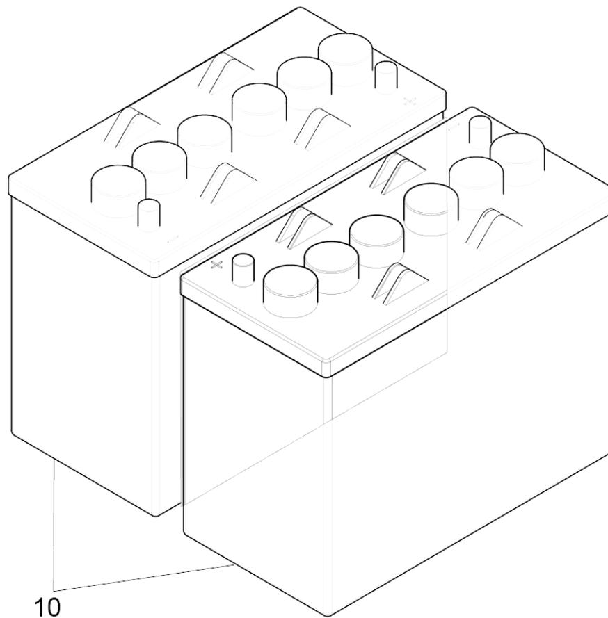
9521 Batteriesatz Gel 2x 12V/105Ah (2.815-100.0)
