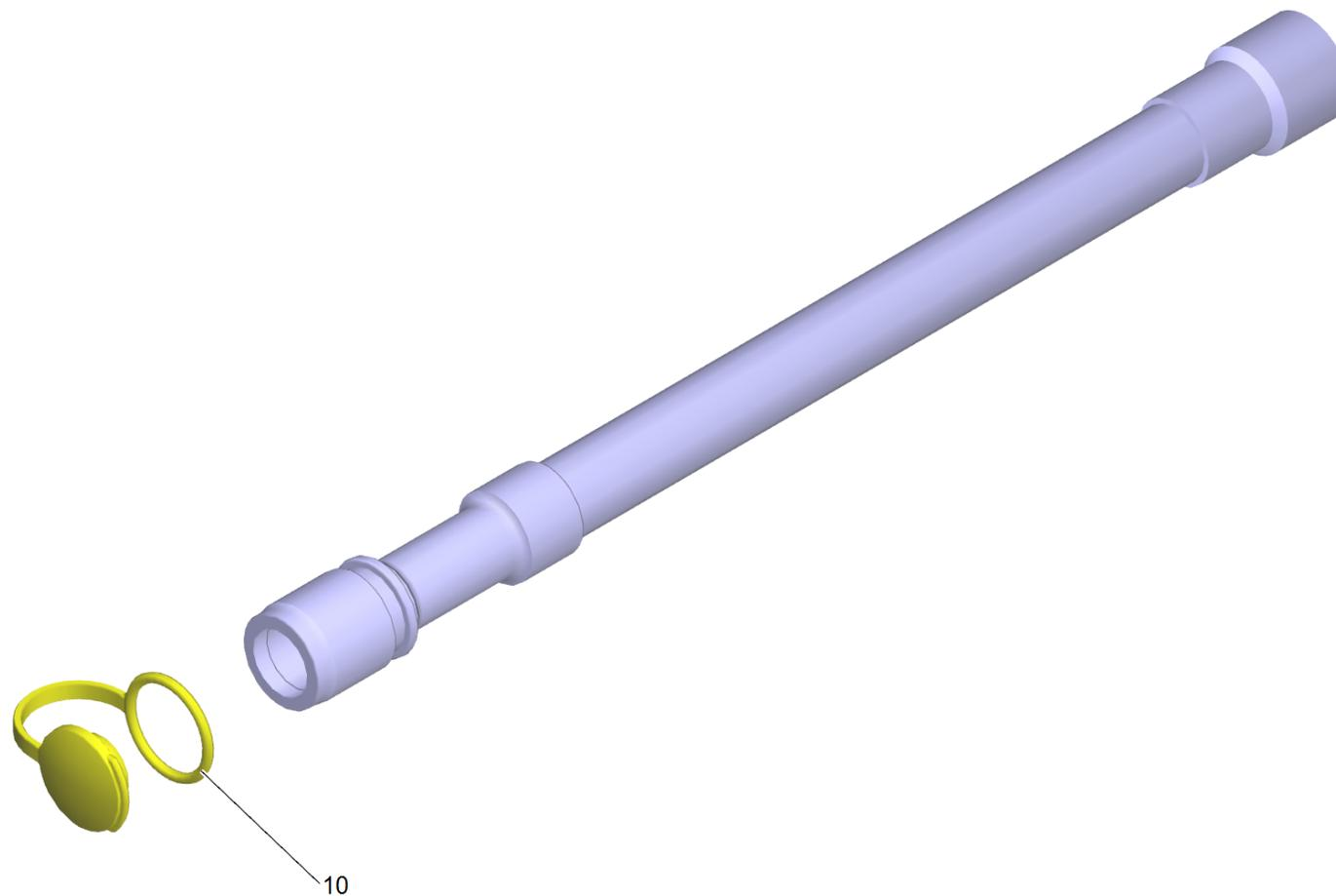
140 Ablassschlauch mit Deckel Ersatz (9.755-646.0)
