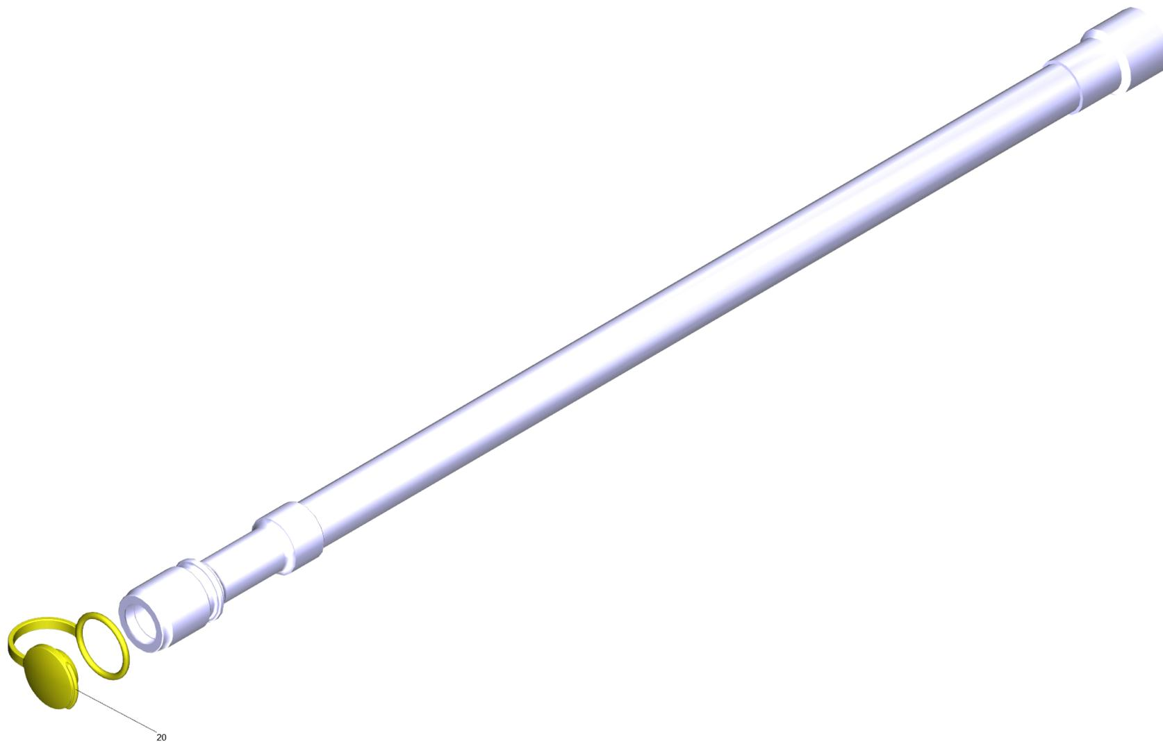
140 Ablassschlauch mit Deckel oelfest B80 (4.035-500.0)
