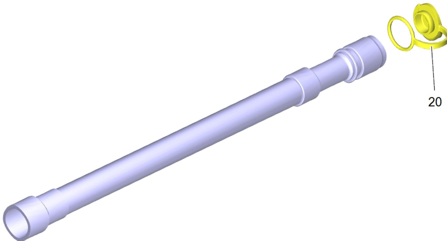
80 Ablassschlauch kpl. PU (9.753-111.0)
