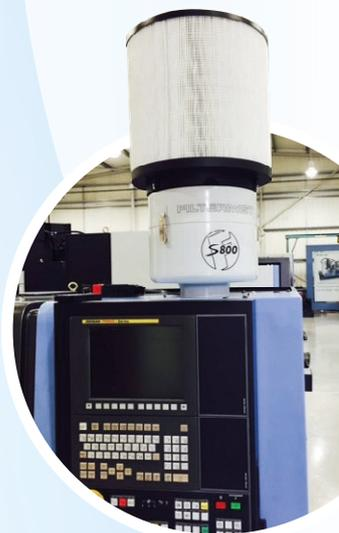
Nach 4000 Stunden im Test, hatte sich der Luftdurchsatz bei dem Filtermist S Fusion nur um 14% reduziert
