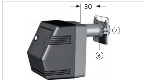
Abb. 19: Montage des Brennerflansches und des Brenners
