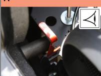
Motor läuft, aber Gerät fährt nicht A Stellung Freilaufhebel prüfen
